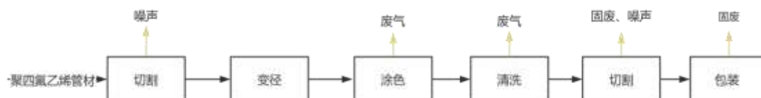
图3-5 项目医疗管生产工艺流程及产污环节图
