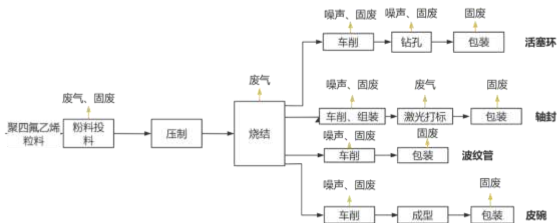
图3-3 项目活塞环、轴封、波纹管、皮碗生产工艺流程及产污环节图
