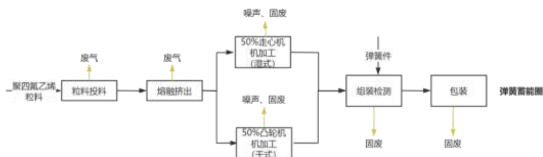
图3-4 项目弹簧蓄能圈生产工艺流程及产污环节图
