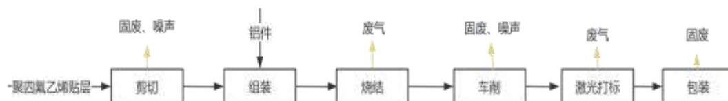
图3-2 项目贴层活塞生产工艺流程及产污环节图
