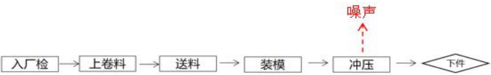
图 3 级进模、连续模生产工艺流程及产污环节图
