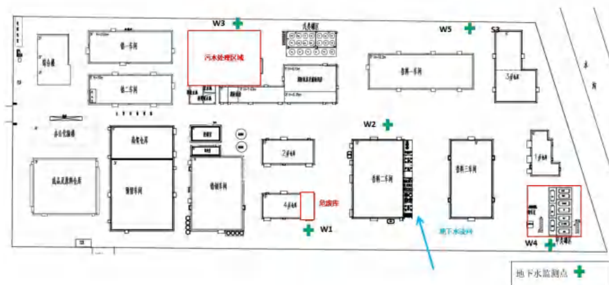
图 4-3 厂区内地下水监控井
